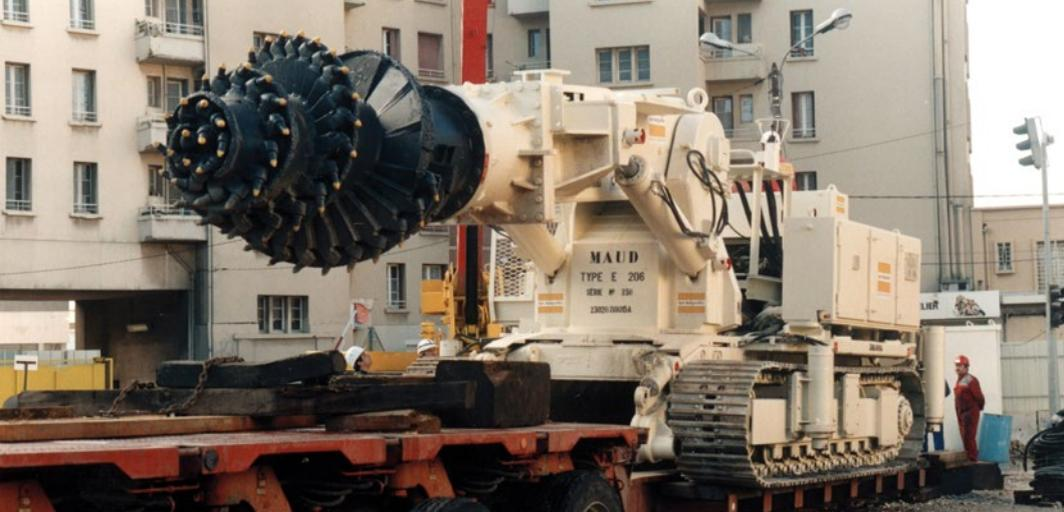
Pour creuser ce tunnel, des fraises mécaniques rotatives d'environ 1,20 m de diamètre ont été utilisées. Elles ont été installées au bout d'une pelle mécanique pesant près de 70 tonnes. Le rythme moyen du creusement du tunnel était d'environ 1,5 mètre par jour.
