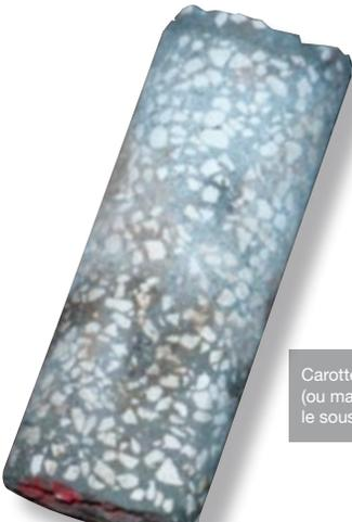
Carotte : le carottage est le prélèvement d'un échantillon du sous-sol terrestre (ou marin) obtenu à l'aide d'un tube appelé carottier que l'on fait pénétrer dans le sous-sol. L'échantillon ainsi obtenu s'appelle une **carotte**.
